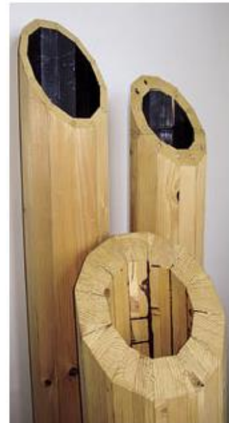
Obr. 3.9 Průřez dutého dřevěného sloupu [1]
